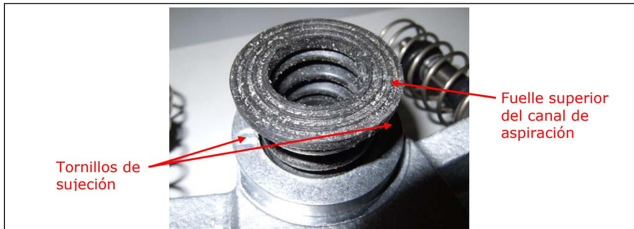
**Figura 53:** Paso 4 cambiar los 2 fuelles, si fuera necesario. El fuelle está sujeto con un anillo fijado mediante dos tornillos.
