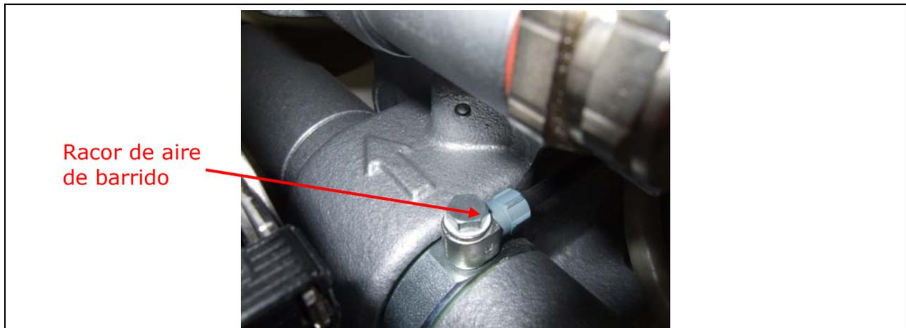
Figura 48: Paso 1 abrir el racor del aire de barrido
