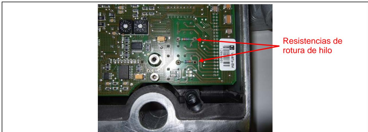
Figura 25: Resistencias de rotura de hilo
