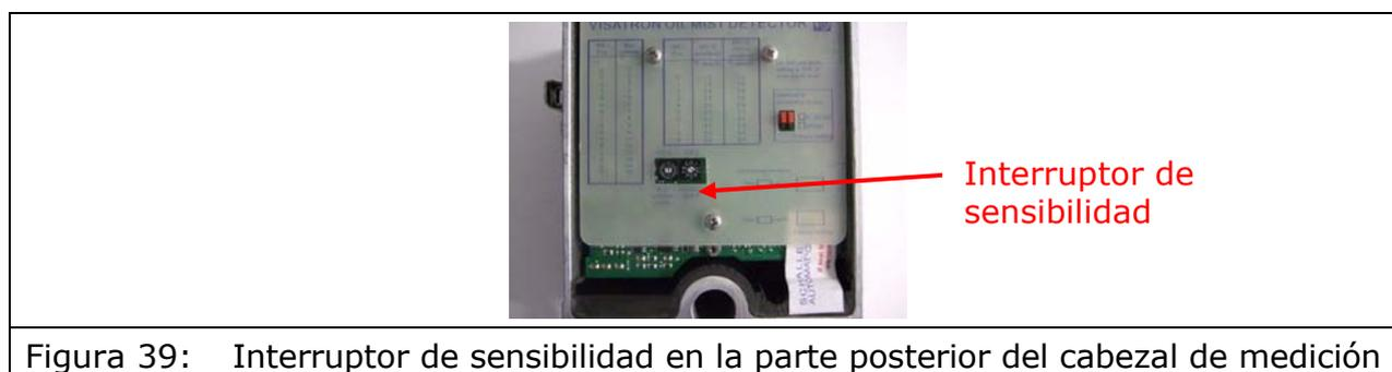
**Figura 39:** Interruptor de sensibilidad en la parte posterior del cabezal de medición
