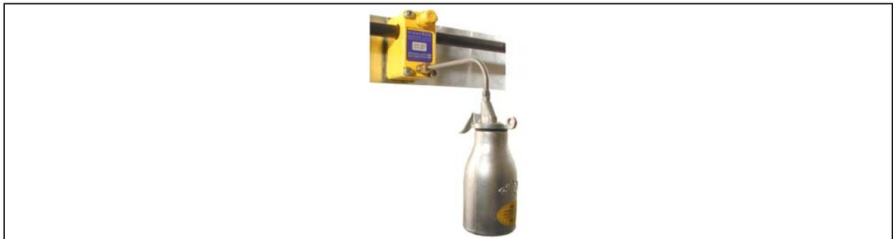
**Figura 37:** Bomba de llenado insertada y fijada en el bloque sifónico
