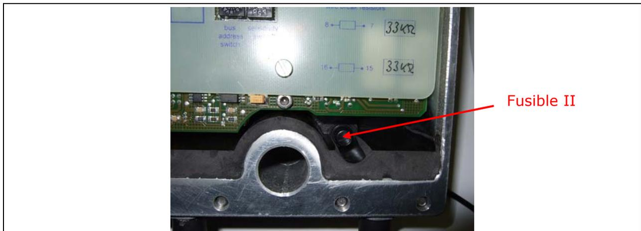
**Figura 55** Fusible en la parte posterior del cabezal de medición
