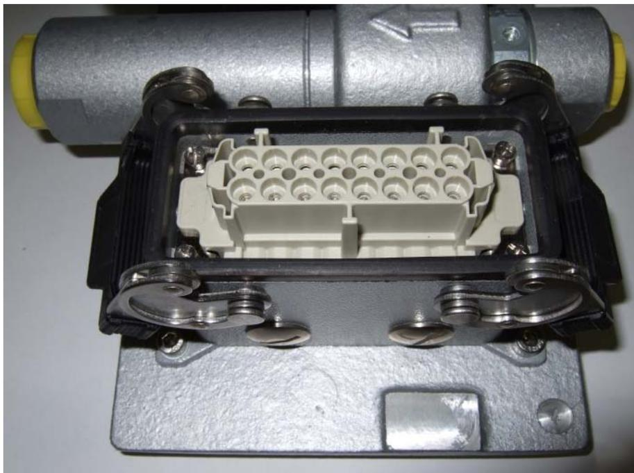
**Figura 33:** Entradas del cable en la parte inferior de los dispositivos VISATRON®
