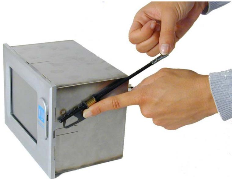
**Figura 30:** Colocación de los tornillos de fijación
